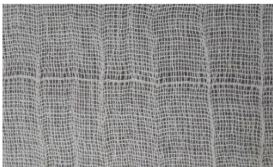
(d) Defect 4. Weft opening.
