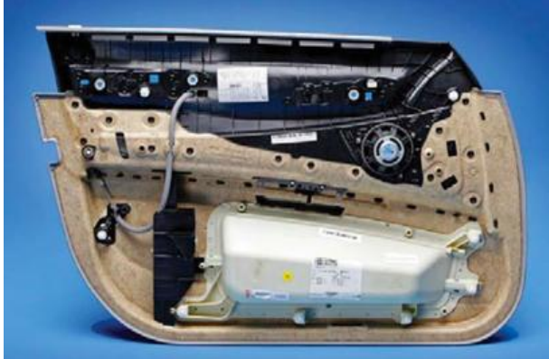
řekil 8. BMW 7 Sedan serisi sıkıřtırma ile kalıplanmıř ve BASF akrilik kopolimerlerden yapılmıř kapı alt paneli (Shinoj, Visvanathan, Panigrahi, and Kochubabu, 2011).
