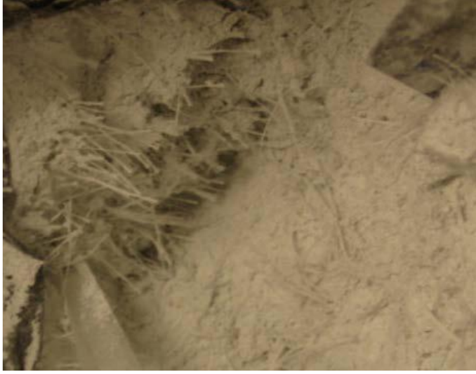
Resim 5. Atık PET ile üretilen betonun yakından görünüşü (Asokan ve ark., 2008)
