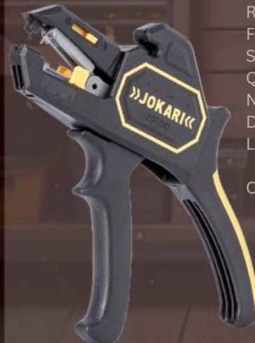
PELACABLES AUTOMÁTICO ERGONÓMICO, PARA CONDUCTORES RÍGIDOS, TRENZADOS Y DE HILO FINO, CUCHILLAS INTERCAMBIABLES, SISTEMA DE APRIETE AUTOMÁTICO QUE AHORRA FUERZA, NO ES NECESARIO AJUSTAR LA SECCIÓN DEL CABLE. AJUSTE INTEGRADO DE LA PROFUNDIDAD DE CORTE.
