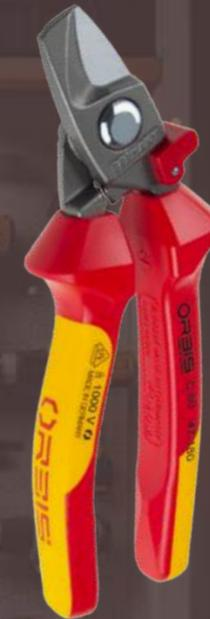
CIZALLA PARA CABLE VDE, CERTIFICACION IEC60900. PROTECCIÓN CONTRA TENSIONES DE HASTA 1000 V. FILO FINO PARA UN CORTE LIMPIO Y SUAVE DE CABLES DE COBRE Y ALUMINIO, ARTICULACIÓN DE FUERZA ATORNILLADA, REAJUSTABLE, MANEJO CON UNA SOLA MANO CON RESORTE Y BLOQUEO INTEGRADO.
