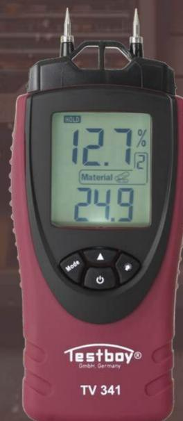
MIDE EL CONTENIDO DE HUMEDAD EN MATERIALES DE CONSTRUCCIÓN COMO MADERA ASERRADA, CONTRACHAPADO, AGLOMERADO, CHAPA DE MADERA, CARTÓN YESO O ESCAYOLA, RANGO DE MEDICIÓN 0- 55 %.
