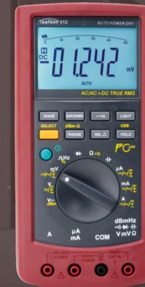
MULTIMETRO PROFESIONAL DE ALTA PRECISIÓN DE MEDICIÓN, MEDICION HASTA 1000 V AC/DC Y 10 A AC/DC, ADEMÁS BRINDA MEDICIÓN DE RESISTENCIA, DIODOS, FRECUENCIA, CONTINUIDAD Y CAPACITANCIA. INCLUYE SOFTWARE DE ANALISIS DE DATOS.
