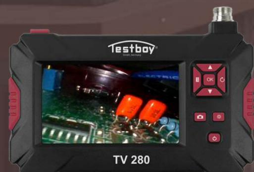
VISUALIZACIÓN MEDIANTE UNA Sonda DE 2 METROS QUE CONSERVA SU POSICIÓN, PANTALLA DE 4,3" ES IDEAL PARA EXPLORAR LUGARES DE DIFÍCIL ACCESO, BRILLO AJUSTABLE E ILUMINACIÓN LED, PROTEGIDO CONTRA LA HUMEDAD. RENAURA PARA TARJETA SD.
