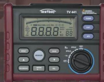
COMPROBACION DE LA RESISTENCIA ENTRE LA TIERRA DE REFERENCIA Y EL PUNTO DE CONEXIÓN DEL EQUIPO DE PUESTA A TIERRA. DE LA TOMA DE TIERRA QUE VA A MEDIRSE, SE MIDE LA CAÍDA DE TENSIÓN Y LA RESISTENCIA A TIERRA.
