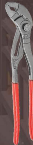
POSEE BOTÓN DE AJUSTE RÁPIDO Y DE AUTOBLOQUEO LO QUE IMPIDE DESPLAZAMIENTOS INVOLUNTARIOS, APERTURA DE MORDAZA HASTA 2 3/4", PARA TUERCAS HASTA 60 MM, DENTADO DIRIGIDO EN SENTIDO OPUESTO CERCA DE LA JUNTA PARA UN AGARRE FIRME.
