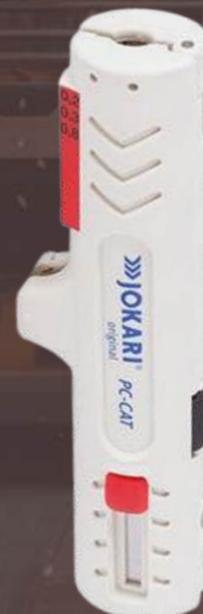
HERRAMIENTA PARA PELAR CABLES CAT Y DE RED CON AISLAMIENTO DE PVC, LAS CUCHILLAS NO NECESITAN AJUSTARSE A LA PROFUNDIDAD DE CORTE. 3 MUESCAS PARA HILOS DE 24 A 18 AWG. CUCHILLAS CON REVESTIMIENTO DE NITRURO DE TITANIO.
