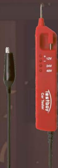
PARA LA LOCALIZACIÓN DE AVERÍAS EN VEHÍCULOS DE COMBUSTION, VEHÍCULOS INDUSTRIALES Y TODOS LOS DEMÁS ÁMBITOS HASTA 48V DC. CUATRO LED INDICAN LA TENSIÓN Y LA POLARIDAD. LA UNIDAD DE PERFORACIÓN INTEGRADA FACILITA LAS PRUEBAS EN CABLES SIN NECESIDAD DE PELARLOS.
