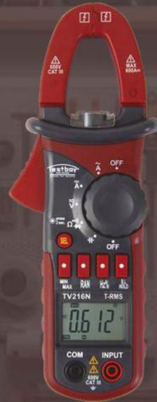
PINZA AMPERIMÉTRICA DIGITAL, MEDICIÓN HASTA 600A AC/DC Y 600V AC/DC CON ILUMINACIÓN AUTOMÁTICA. ADEMÁS BRINDA MEDICIÓN DE RESISTENCIA, DIODOS, CONTINUIDAD, FRECUENCIA Y CAPACITANCIA.
