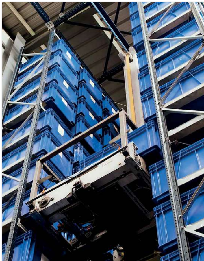
SISTEMA DE ALMACÉN Y DISPENSACIÓN ROBOTIZADO DE PRODUCTOS ROBOTIC WAREHOUSING AND PRODUCT DISPENSING SYSTEM
