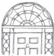
Fig. 137. MONTANTE DE ABANICO
