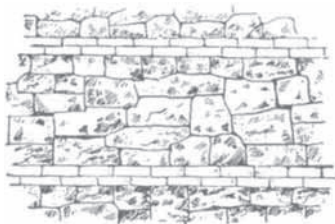
Fig. 125. MAMPOSTERÍA ORDINARIA CON VERRUGADAS
