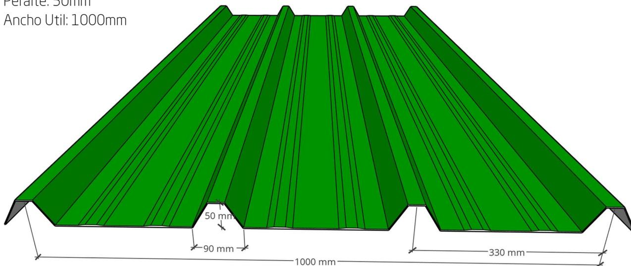
Cara superior e inferior Base de acero en laminado en frio con revestimiento metálico
