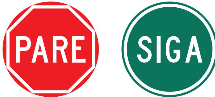
En este sistema de control de tránsito, personal de la obra, trabajadores comúnmente llamados Auxiliares de Tránsito, otorgan el derecho de paso alternado, utilizando la Paleta portátil PARE / SIGA. Ver Figura 4-23.
