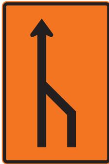
Esta señal informa sobre el fin del carril derecho en una calzada unidireccional de dos carriles.
