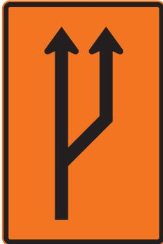
Esta señal informa sobre la generación de un carril al lado derecho en una calzada unidireccional de un carril.
