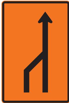
Esta señal informa sobre el fin del carril izquierdo en una calzada unidireccional de dos carriles.
