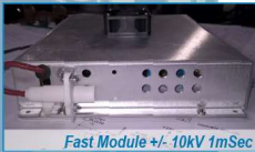
Fast Module +/- 10kV 1mSec
