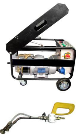
Bir ana bileşen ve bir katalizörden oluşan Ultramast iki ayrı girişi ve çıkışları olan havasız soğuk sıvı membran kauçuk püskürtme makinası ile uygulanır. Bir püskürtme ucu Ultramast'ı püskürtür ve ikincisi sertleşme hızlandırıcıyı(katalizörü) püskürtür..
