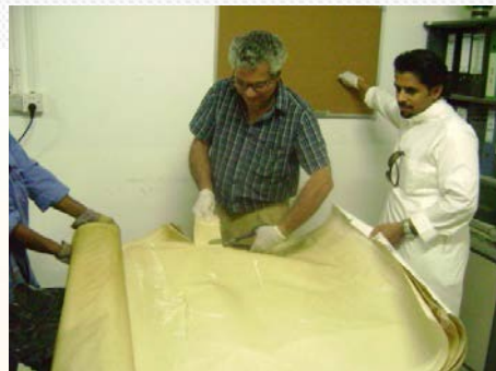
On-site membrane autopsy
