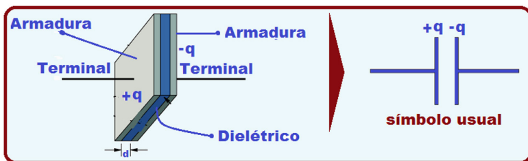
Figura 1: Figura esquemática de um capacitor de placas paralelas ou capacitor plano. À direita, o símbolo gráfico usual de um capacitor.
