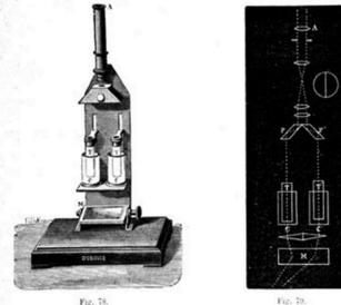
L'observation ne peut être faite qu'à l'aide d'une lumière monochromatique fournie par un fort brûleur **Bunsen**, dans la flamme du quel on place du chlorure de sodium fondu.
