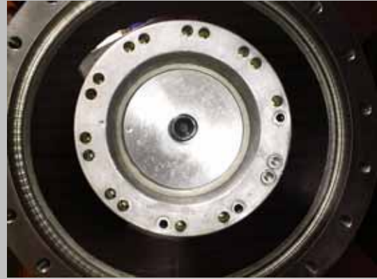
圖 Figure 3-21 固定馬達轉部 Fix the motor rotor.
