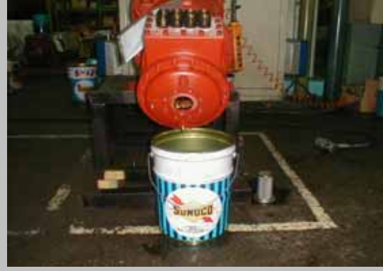
圖 Figure 2-2-2 排放潤滑油/ Drain Oil.
