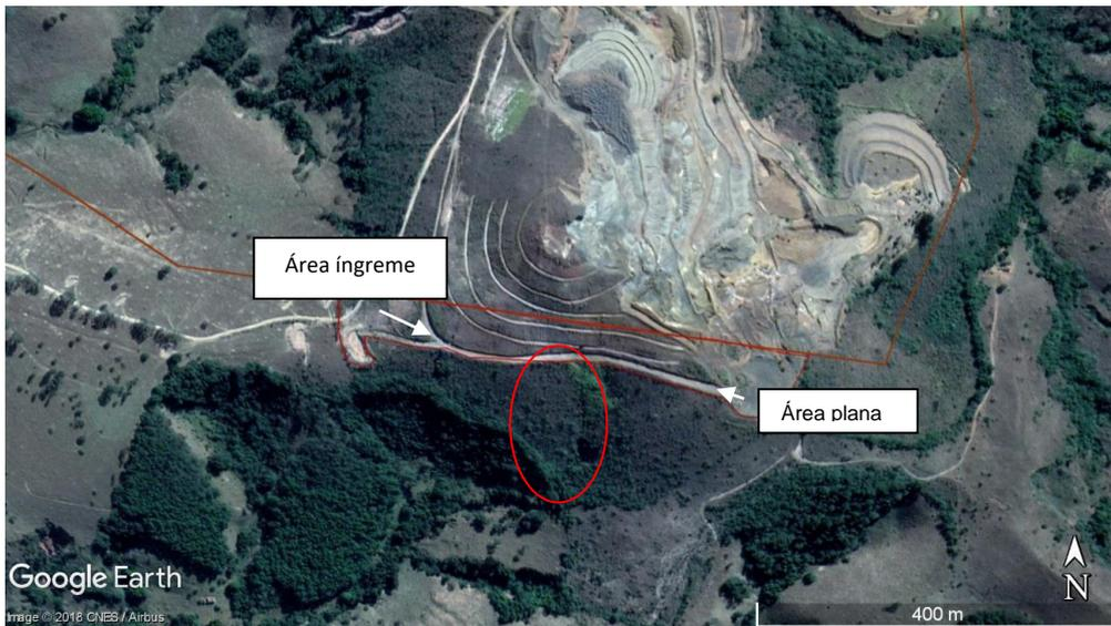
Figura 23 - Retirada da pilha na área plana e recuperação da voçoroca.
