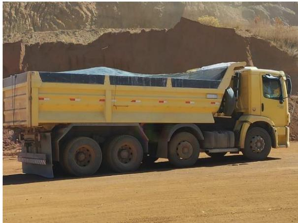
Figura 20 – Enlonamento de caminhão na Mineração Morro do Ferro
