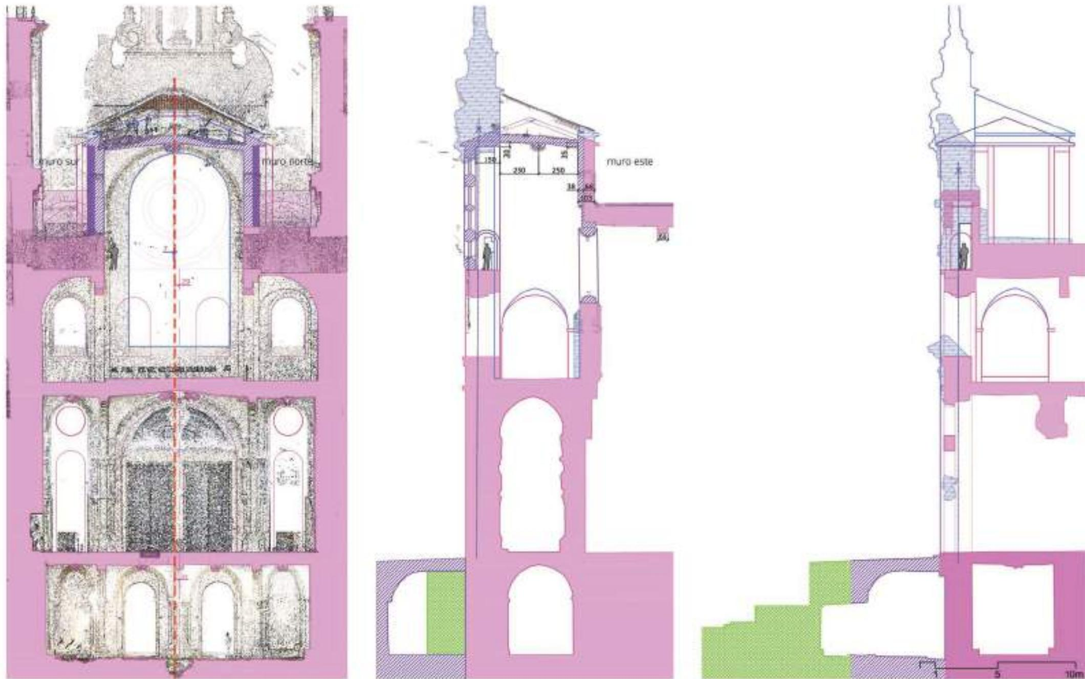
"Intervenciones de Fernando de Casas". Sección transversal por el nártex y tribuna. | Sección longitudinal por la clave de la bóveda de tribuna. | Detalle del remonte del plemento del último tramo de la bóveda. | Sección longitudinal por el ándito sur.
