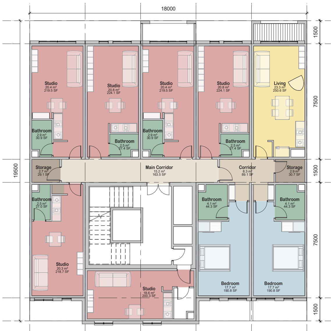
Рис.36 Концепція плану будівлі ущільнювальної забудови №2 / масштаб 1:200
