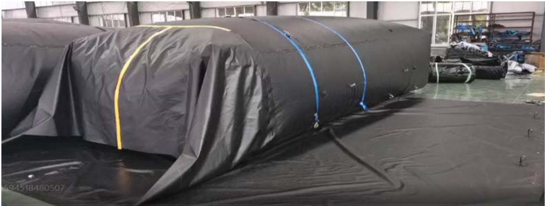
Prueba de presión de fábrica de barrera de 72 pulgadas
