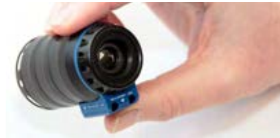
irGO: Cámara termográfica en miniatura
