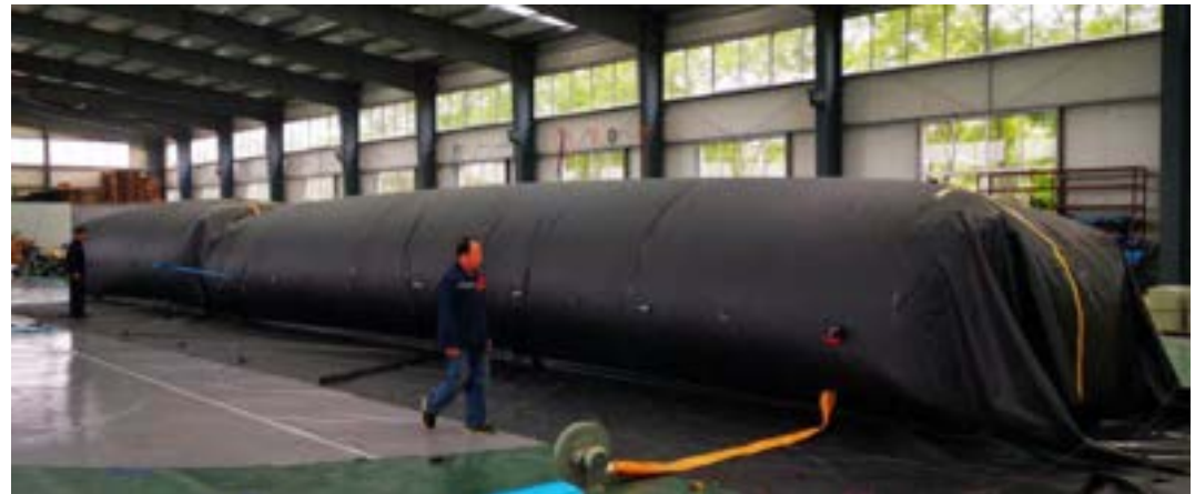
Foto de fábrica de 72 pulgadas x 25 pies y 72 pulgadas x 50 pies barreras unidas juntas
