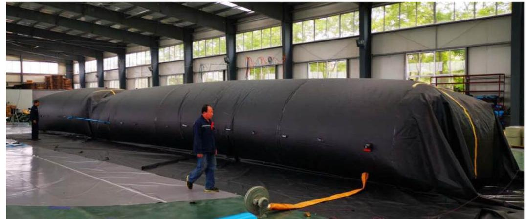
Foto de fábrica de 72 pulgadas x 25 pies y 72 pulgadas x 50 pies barreras unidas juntas
