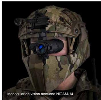
Monocular de visión nocturna NiCAM-14
