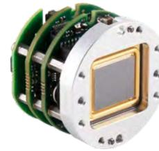
MicroCAM 3 es un núcleo de imagen térmica en miniatura de bajo consumo para aplicaciones rentables de fabricantes de equipos originales. Las opciones XTi con y sin obturador están disponibles con una gama de detectores y rendimientos diferentes.
