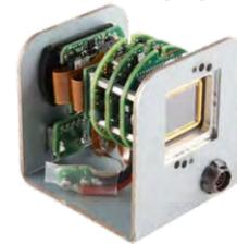
O Kit de Câmara a Termal MicroCAM 3 é baseado em um núcleo de imagem térmica MicroCAM 3 junto com uma placa de solução inteligente e um visor OLED, prontos para a integração em qualquer projeto ou soluções OEM de imagem térmica independente e do invólucro que será utilizado.
