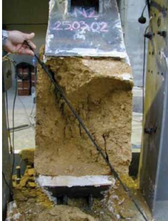
Şekil 20. İki eksenli kuvvet deneyi: yığma duvarda iki eksenli kuvvet uygulaması.
