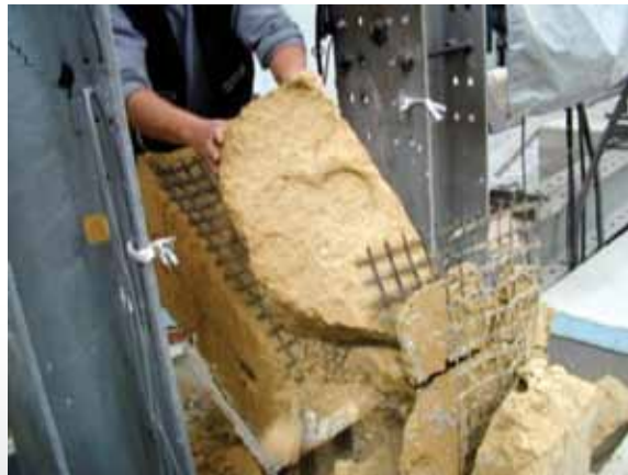
Şekil 21. İki eksenli kuvvet deneyi: yığma duvarda kaydırma düzlemleri.
