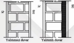
DUVAR 2 (yalıtımlı). Dış sıva (2,5 cm) Tuğla duvar (20 cm) Isı yal. (2,5 cm) İç sıva (2,5 cm) Duvar Kalınlığı=27,5 cm
