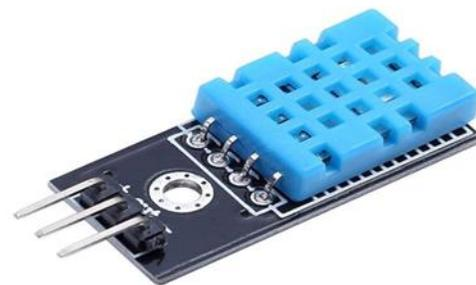
Figure 15 DHT-11 Assembled (OSEPP, 2018)
