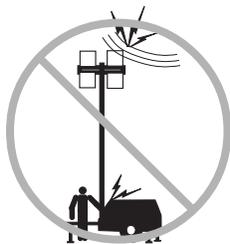
Aléjese de la máquina si ésta entra en contacto con líneas eléctricas activas. El personal no debe tocar ni manejar la máquina hasta que las líneas eléctricas hayan sido desconectadas.
