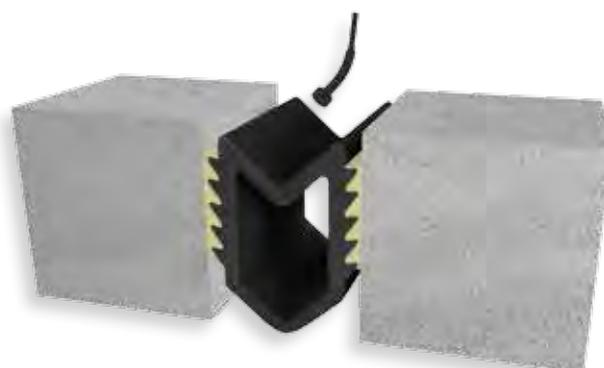
6 - Após a cura do adesivo remover a válvula de pressurização.
