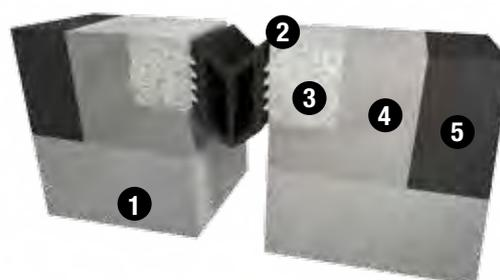
1 - laje estrutural 2 - selante JEENE® 3 - lábio polimérico 4 - berço de transição 5 - pavimento asfáltico
