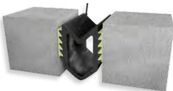
5 - Pressurizar e remover o excesso de adesivo.
