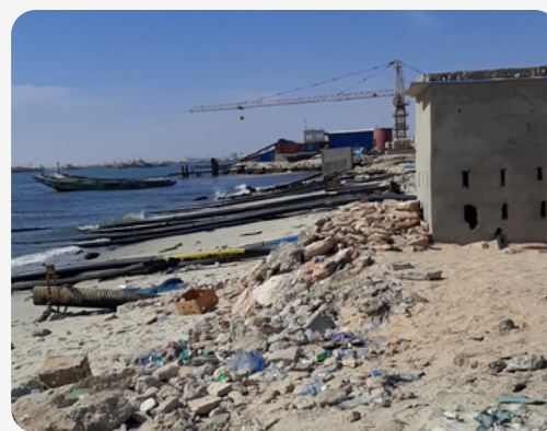
FIGURE 18 : Tuyaux transférant le poisson entre les bateaux et les usines et/ou camions en Mauritanie
