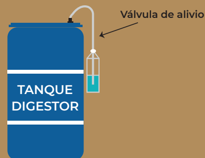
Esquema general del tanque biodigestor con válvula de alivio
