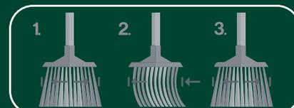
Los monofilamentos se adaptan a la dirección de barrido sin deformarse por el uso.
