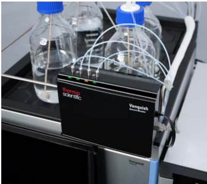
Monitor de Disolventes Vanquish gestiona su nivel de eluyente y residuos para obtener la máxima confianza durante el análisis.
