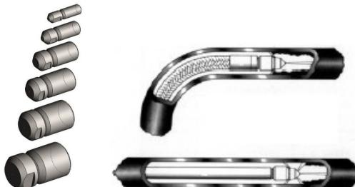
RB Bico fixo para aplicações em limpeza interna de tubos de Ø 1/2 a 1 polegada com lance flexível ou mangueiras. Indicado para limpeza de tubulações obstruídas onde existem curvas acentuadas na tubulação. Construído com jatos frontal e radiais a 45°. Conexões padrão rosca fêmea NPT.
