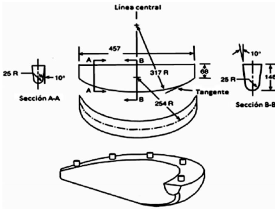
Figura 2 A.- Eschema del bloque metálico patrón usado en la prueba de resistencia de la ceja al
