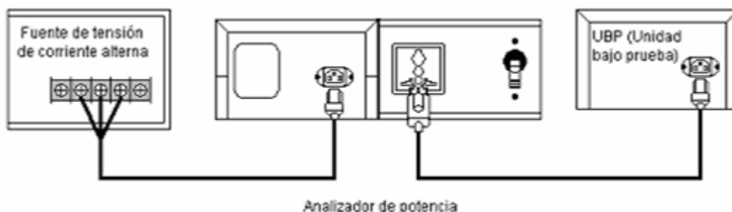
Figura 3. Arreglo de pruebas para las mediciones de potencia eléctrica en espera
