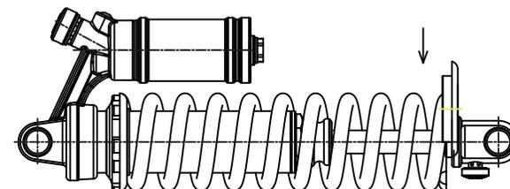
7. Otra vez aplique con un gran fuerza contra el lado del amortiguador, Otra vez aplique con un gran fuerza contra el lado del amortiguador, en cuando se comprima el muelle, el fiador deslizará a su posición original.
