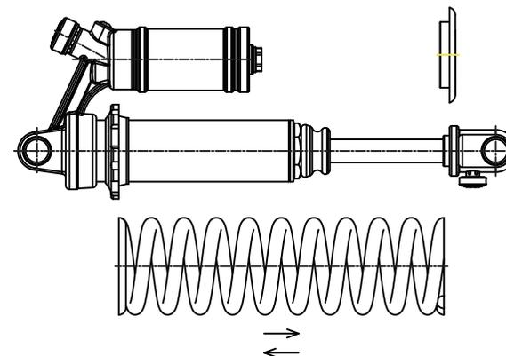
6. Volver a instalar el fiador como lo que muestra en el dibujo. Deje que la parte plana del muelle siga quedando afuera.
