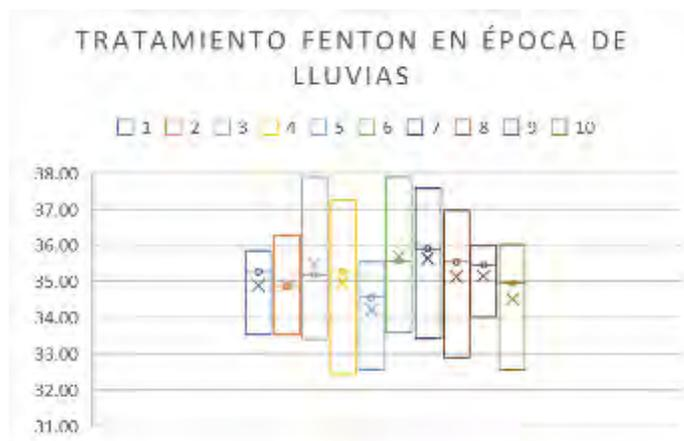
Figura 3. Resultados del tratamiento del lixiviado con reactivo Fenton en época de lluvia.
