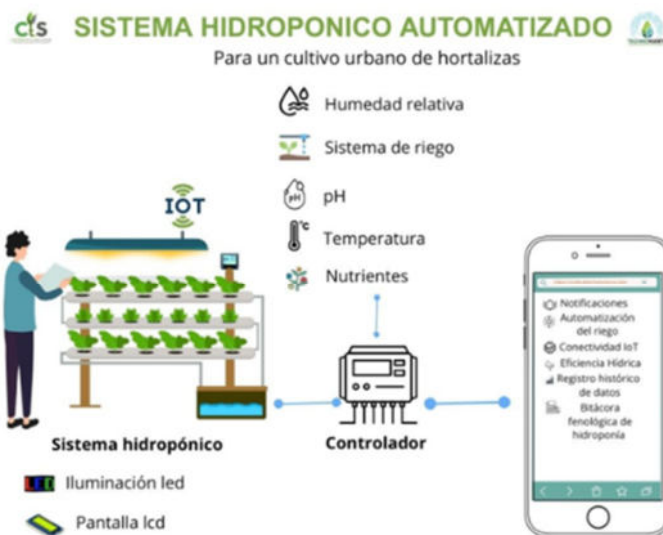
Figura 1. Diseño del Prototipo para un sistema acuapónico automatizado.
