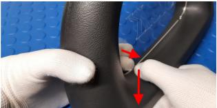
Die Haltenasen sind abgerundet und beschädigen Ihren Überrollbügel nicht. Sie halten den Einsatz im der geschäumten Ummantelung form- und kraftschlüssig. Nach der Demontage bilden sich die kleinen Druckstellen binnen kurzer Zeit wieder komplett zurück.
