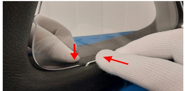
Die Haltenasen sind abgerundet und beschädigen Ihren Überrollbügel nicht. Sie halten den Einsatz in der geschäumten Ummantelung form- und kraftschlüssig. Nach der Demontage bilden sich die kleinen Druckstellen binnen kurzer Zeit wieder komplett zurück.
