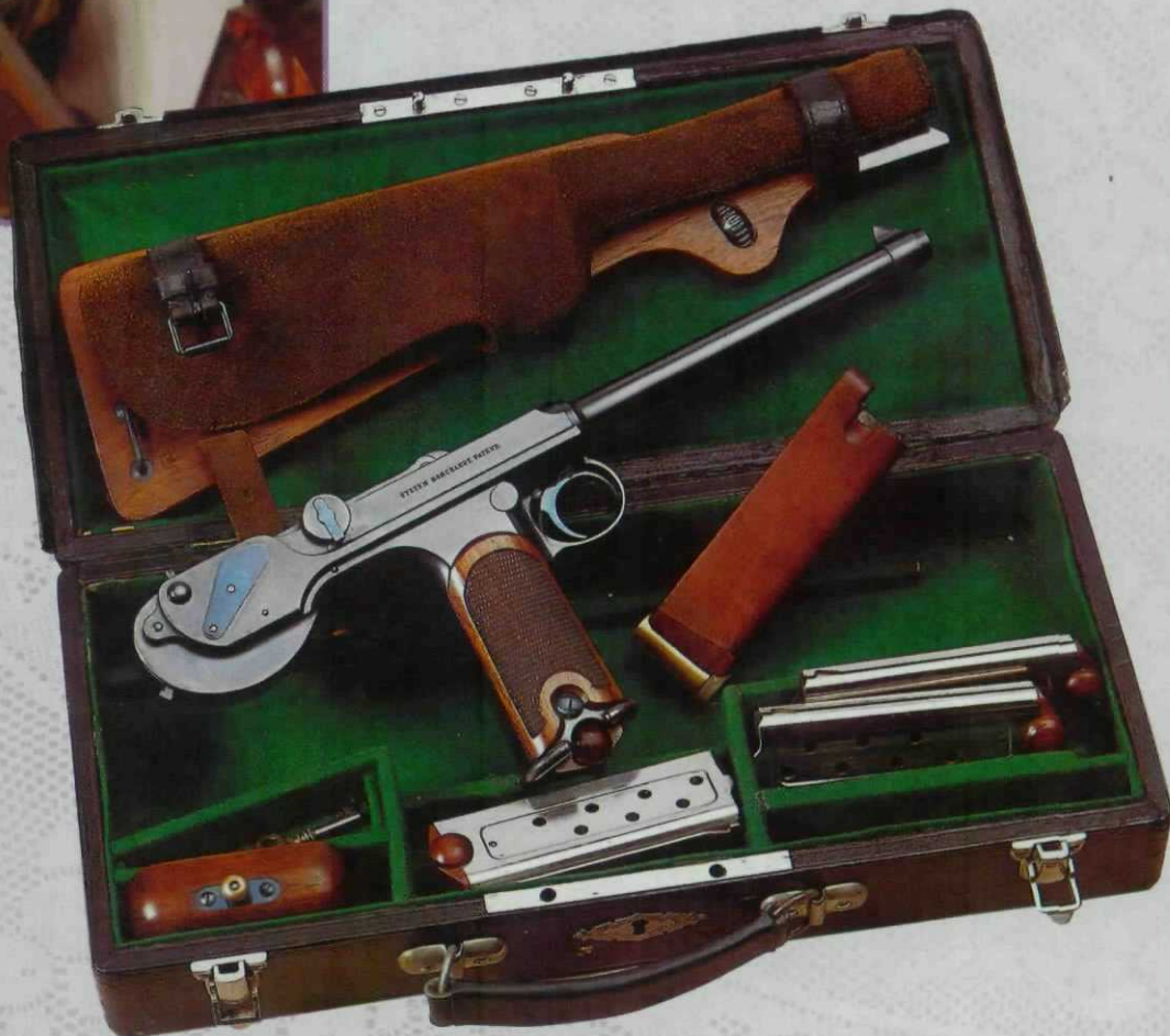
Hugo Borchardts bei Loewe in Berlin gefertigte C 93 bildete die Grundlage für Lugers Parabellum-Pistole. Links die Pistole geöffnet, der Verschuß mit einem Holzeinsatz zurückgehalten. Unten die Borchardt im Kasten mit Anschlagbrett und Tasche, Reservemagazinen und dem Holzeinsatz zum Reinigen, der auch Fettbüchse und Putzstock enthält.
