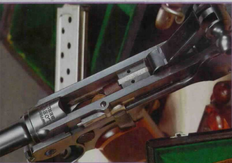
Hugo Borchardts bei Loewe in Berlin gefertigte C 93 bildete die Grundlage für Lugers Parabellum-Pistole. Links die Pistole geöffnet, der Verschuß mit einem Holzeinsatz zurückgehalten. Unten die Borchardt im Kasten mit Anschlagbrett und Tasche, Reservemagazinen und dem Holzeinsatz zum Reinigen, der auch Fettbüchse und Putzstock enthält.
