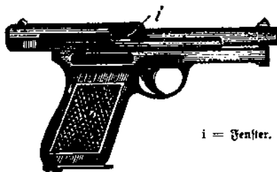
Verschlussstück nach dem Abfeuern in hinterster Stellung.
