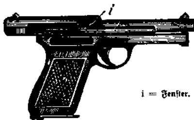
Verchlußstück nach dem Abfeuern in hinterster Stellung.
