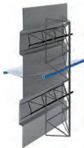
mit Fugenblech und Injektionsschlauch with water stop and injection hose
