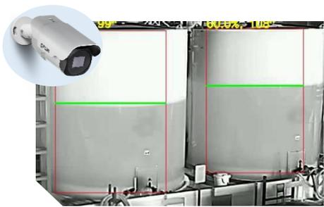
La medición de niveles de tanques utilizando cámaras térmicas de FLIR es una técnica que se basa en la capacidad de estas cámaras para detectar diferencias de temperatura en las paredes exteriores del tanque. Los líquidos almacenados en los tanques tienen una temperatura diferente a la del espacio vacío sobre ellos. Esta técnica es útil para monitorear niveles de tanques que contienen reactivos químicos, combustible, agua, alcoholes, subproductos, residuos u otros líquidos.
