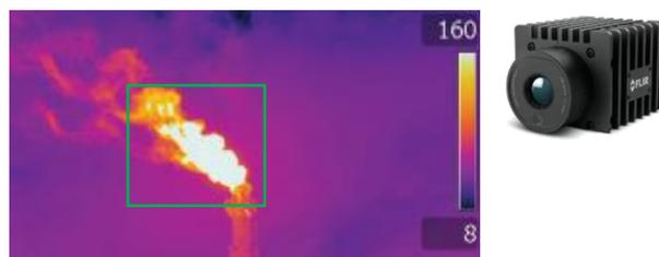
DETECCION DE LLAMA CON SENSOR INTELIGENTE RADIOMETRICO PARA INSTALACIONES FIJAS FLIR A50e
