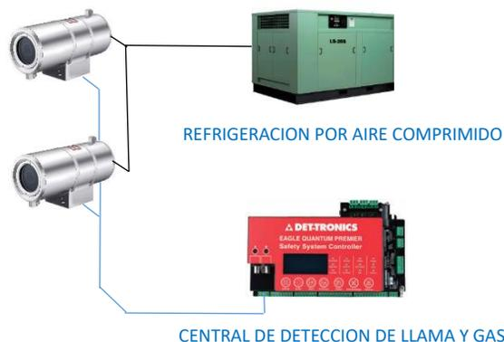
Dentro de las casetas de turbinas compresoras de gas natural, la temperatura de operación puede alcanzar hasta 90°C. Los detectores de llama IR3 no logran operar adecuadamente en ambientes tan hostiles. En poco tiempo salen de operación. Los **sensores radiométricos inteligentes FLIR A50e** están diseñados para operar dentro de housings ATEX refrigerados que soportan temperaturas de operación de hasta 120°C.
