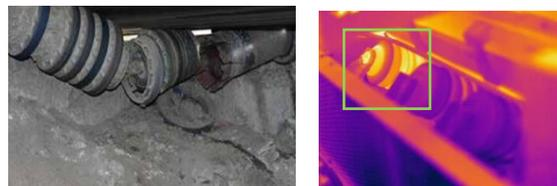
Rodillo de soporte inferior defectuoso en cinta transportadora
