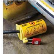
Electrical Equip Lockout
