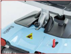
Lange vlakke vloerplaat
