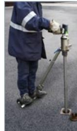
Ejemplo de utilización con una válvula enterrada
