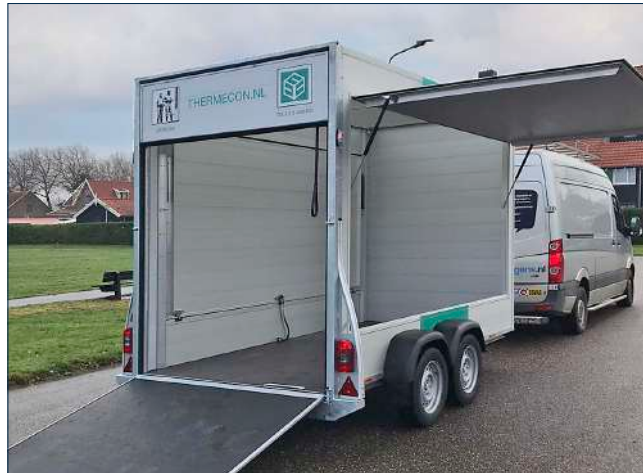
Zijklep met gasveren • Side ramp with gas struts • Seitliche Rampe mit Gasfedern inks • Valve latérale avec ressorts à gaz
