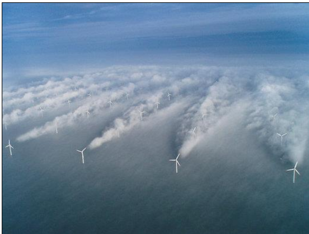
Figure IV.6-6 : Effet de sillage sur le parc éolien en Mer du Nord d'Horns Rev (parc offshore, Danemark) (source : www.eolienne.f4jr.org ).
