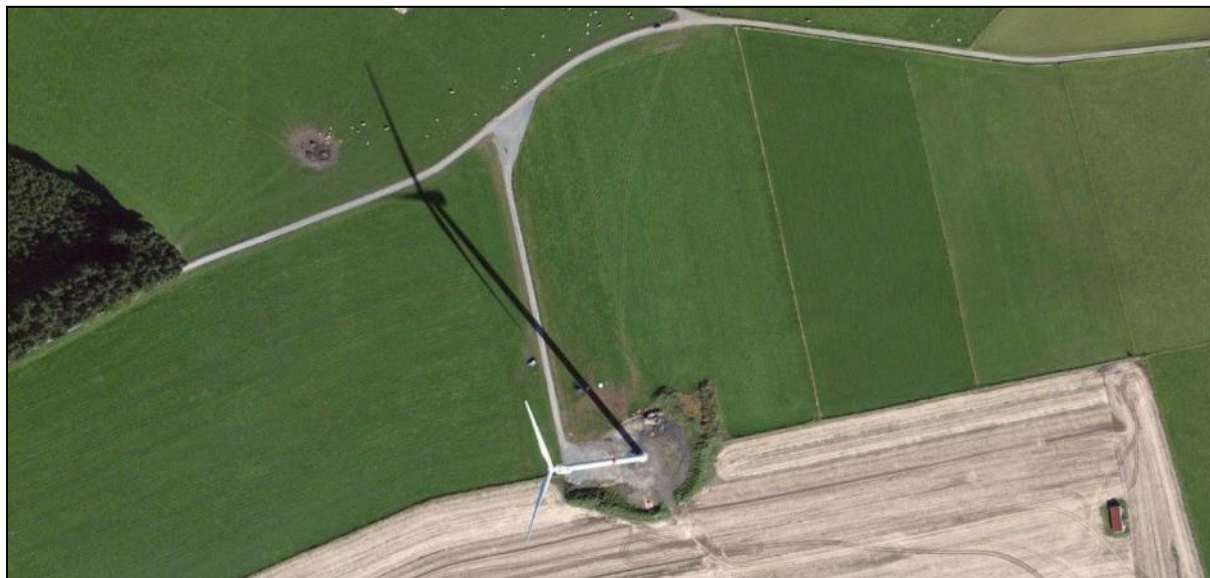
Figure IV.4-5 : Ombre d'une éolienne. L'observateur placé dans l'ombre du rotor subit un effet stroboscopique.
