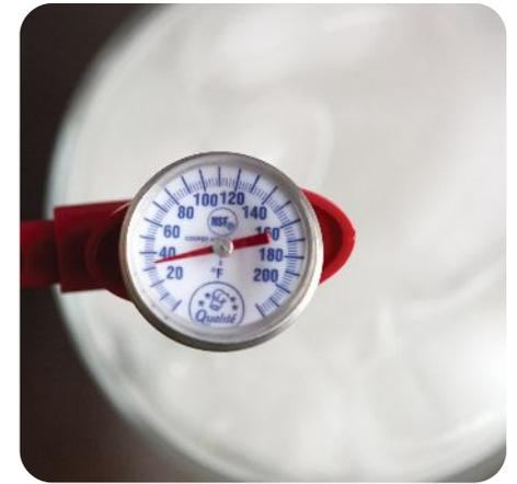
3. Ajuste el termómetro para que muestre 32°F (0°C).
