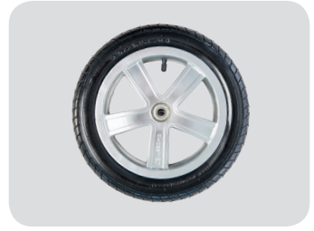
Wheel duże, pompowane, silver metallized (Instead of / in addition) Wheel 12" x 2" 1/2 srebrna felga. Możliwość zamówienia również samej dętki lub opony.
